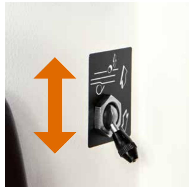
Quick pneumatic exclusion of feeding before surface planer. Schnelle pneumatisch Ausschaltung des Vorschubes vor der Abrichtspindel.
