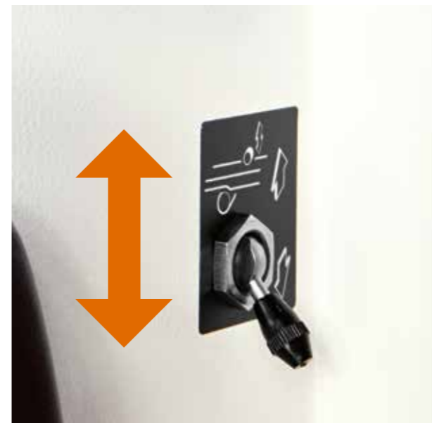
Quick pneumatic exclusion of feeding before surface planer. Système d'exclusion pneumatique rapide du groupe d'avancement avant l'arbre dégaug.
