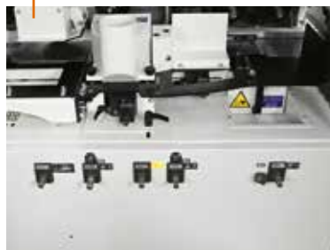
Adjustments Mechanical readouts for spindles setting Compteurs numériques pour positionnement des groupes opérateurs
